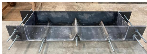
Figura 1. Molde utilizado para avaliação da retração plástica.
