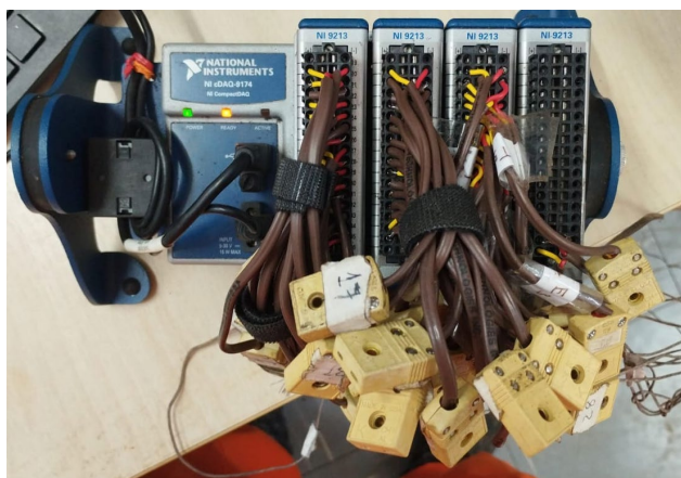
Figura 2 – Receptor de dados para registro de temperatura.
