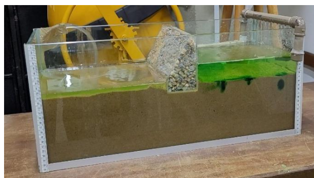
Figura 14. Início da observação das linhas de fluxo.
