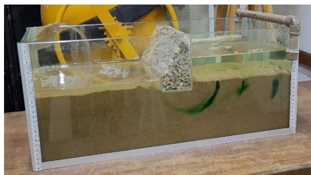
Figura 15. Segunda captura da formação das linhas de fluxo.
