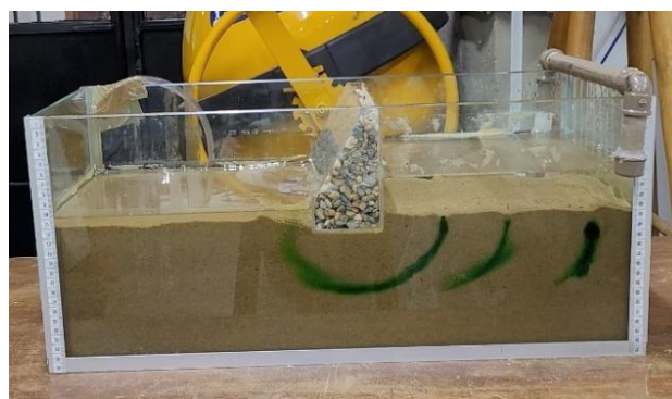
Figura 16. Terceira captura da formação das linhas de fluxo.
