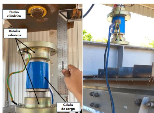
Figura 3.2.2. Posicionamento e montagem do sistema de carregamento
