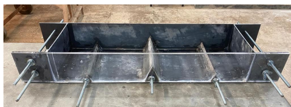
Figura 1. Molde utilizado para avaliação da retração plástica.
