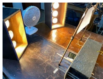
Figura 2. Aparato de controle da umidade e temperatura.
