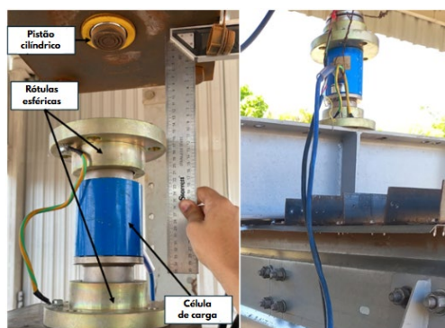
Figura 3.2.2. Posicionamento e montagem do sistema de carregamento
